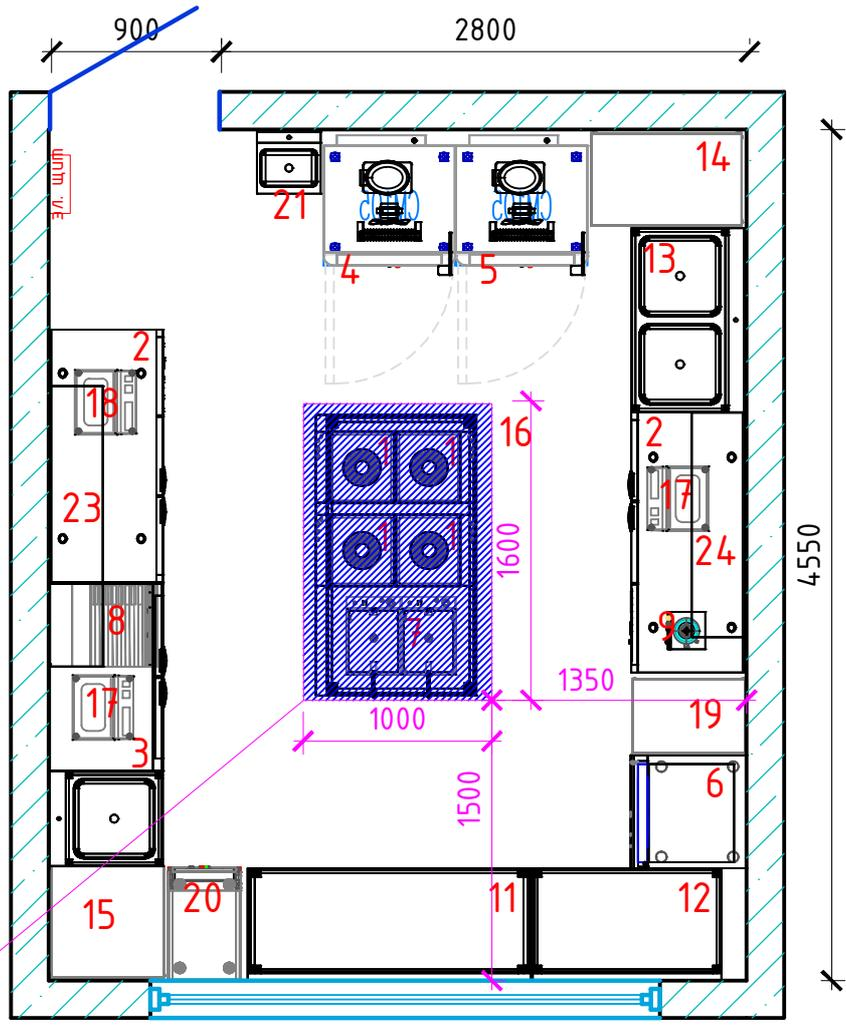
Вытяжной зонт 1600x1000 мм
